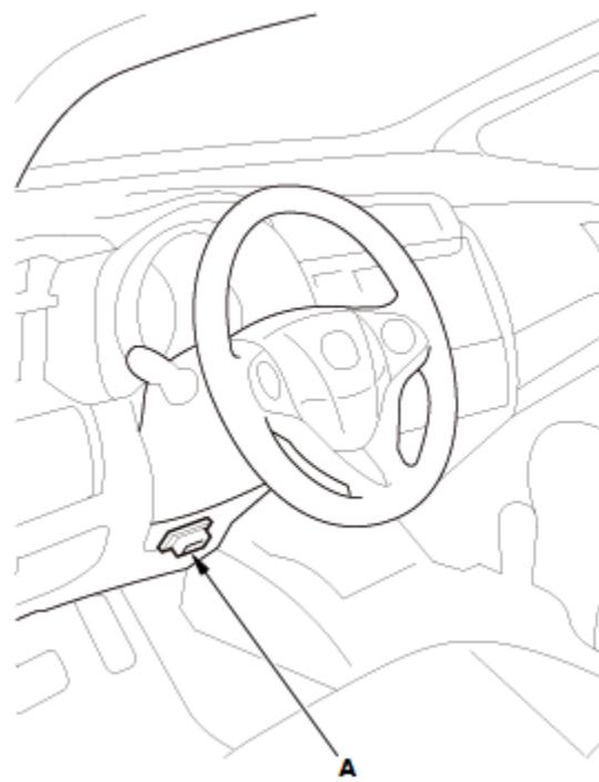
1. 将 HDS 连接到位于驾驶员侧仪表板下的数据插接器 (DLC) (A) 上。
